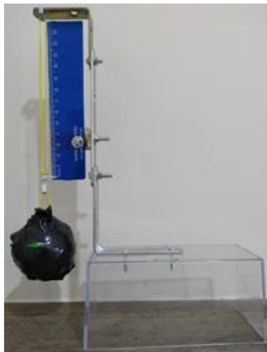
Figura 1.3: Pêndulo de elástico montado.
