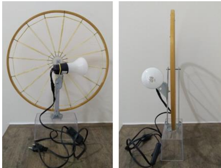
Figura 1.9: Motor de elásticos montado.
