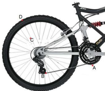
**Figura 2.7.** Esquema de uma bicicleta com pontos específicos para a demonstração da transmissão de movimentos.
